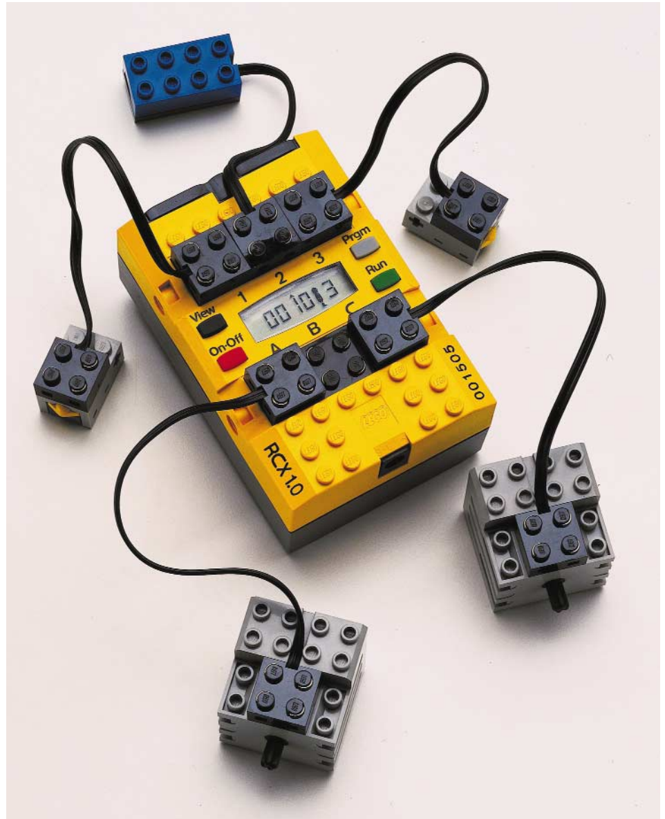
Bild 1. Ein Lego-Baustein voller Elektronik: der RCX-Block.
