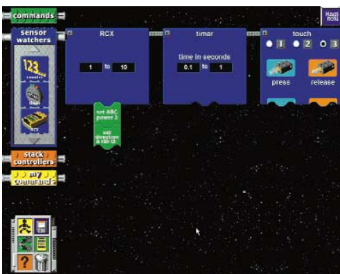
Bild 4. So werden die Sensoren eingestellt.
